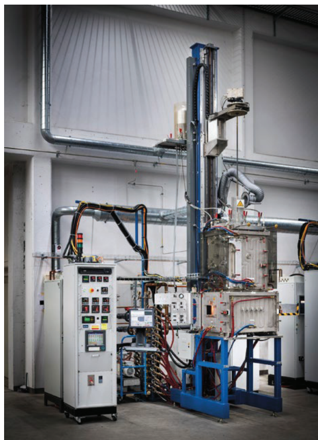
Fig. 5 : Équipement EFG pour l'étrépage des plaques dans l'usine de Comadur à Bad Zurzach (AG).
