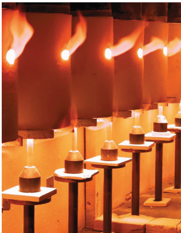
Fig. 3 : Rampes Verneuil en opération. Les cristaux en gestation se trouvent à l'intérieur de moufles réfractaires.
