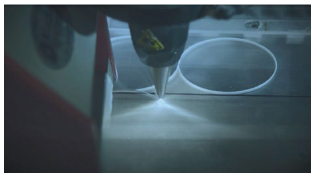
Fig. 9 : Découpe laser des préformes dans les plaques de saphir obtenues par EFG.
